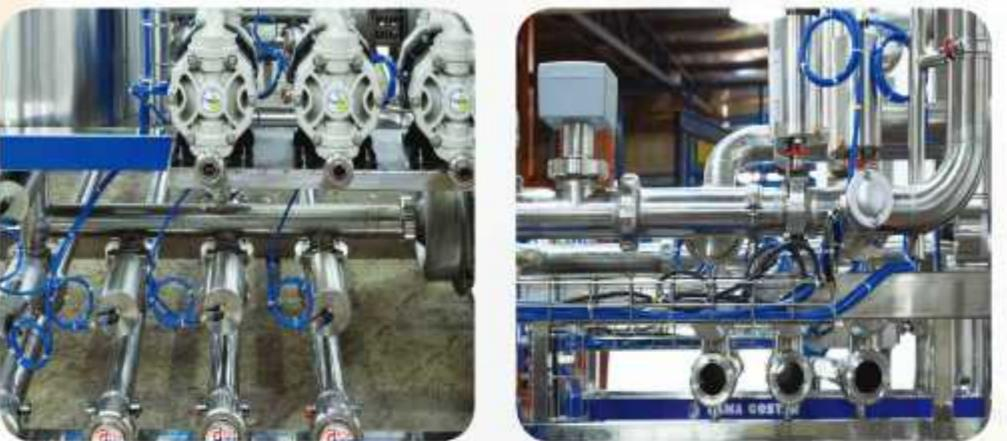
طراحی یوتیت های DG DAM CIP بصورت مستقل از مخازن سود و اسید، امکان حضور آن ها را در خطوط تولید در کنار سایر تجهیزات بدون برخورد هر نوع آبودگی فراهم آورده است ضمن اینکه کاربردی نمودن اپراتوری موجب افزایش دقیق شستشو همراه با حفظ دما و غلظت محلول های شستشو دهنده و کنترل میزان آن برحسب لیترافر گردیده است . در این نسل از تولیدات یوتیت های 15000L/H - 35000L/H قابل طراحی و ساخت می باشد.
